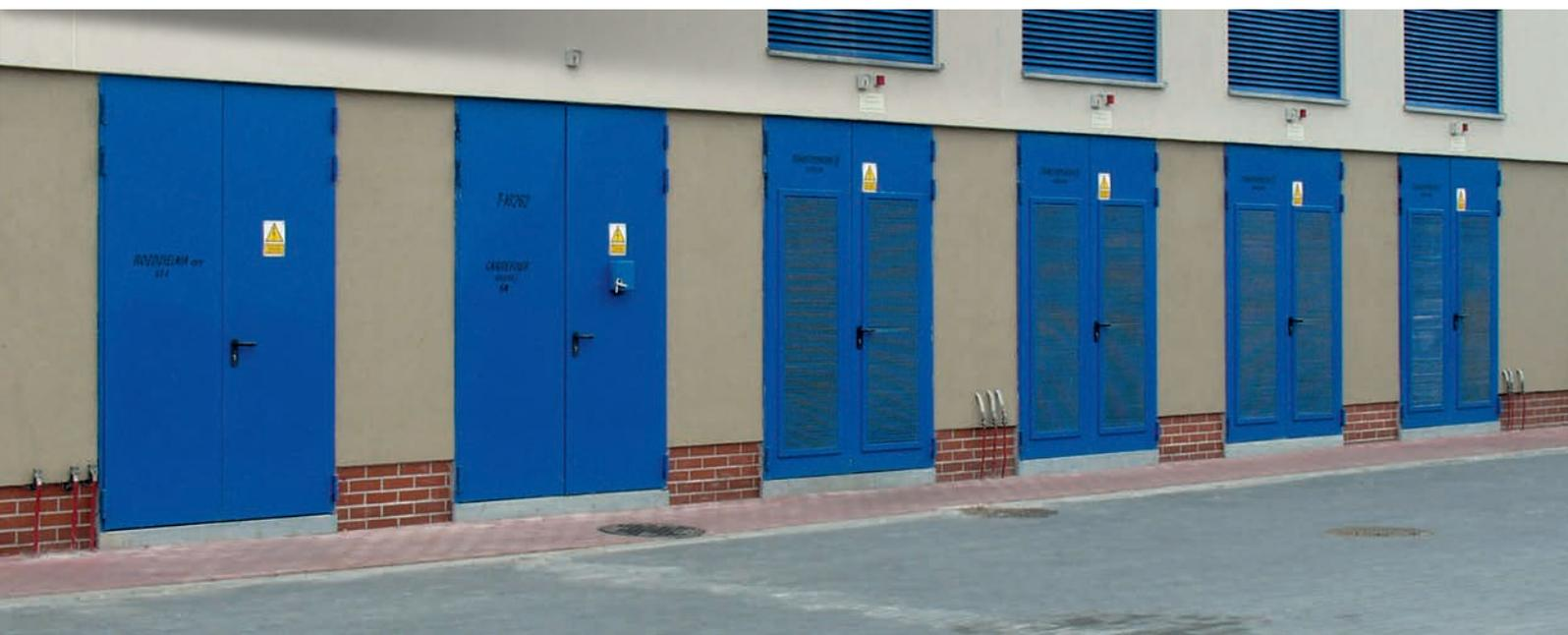
Используются в качестве типичных дверей для трансформаторных станций, где необходима вентиляция. Они также доступны в противопожарном варианте (в случае пожара, вентиляционная решетка закрывается автоматически).
