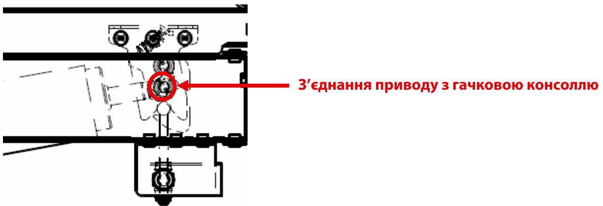
Рис.24. З'єднання приводу з траверсом стулки оснащеним гачковою консоллю (JOFO, GRASL/K+G). На рисунку показано гачкову консоль закриту на «Т»-болт
